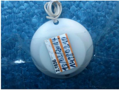
figure 5 : Capteur d'enregistrement Coin T (Capteur numérique RFID à diode, Naocom)
