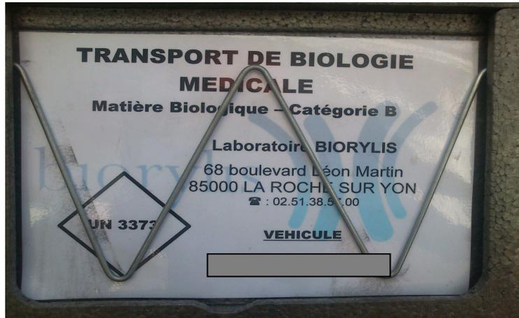
figure 7 : Identification réglementaire (ADR) du contenant employé pour le transport des échantillons
