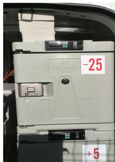
figure 4 : Enceinte thermostatée (+5°C ou -18°C) de transport à température ambiante (Koala) équipant les véhicules de tournée interlaboratoire
