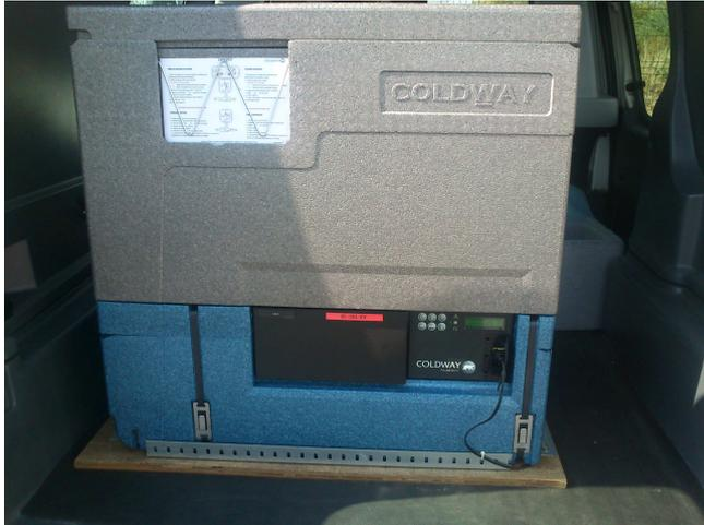
figure 3 : Enceinte thermostatée (chaud/froid actif) de transport à température ambiante (Alcatherm Coolsplit – CO75, Coldway ou Koala) équipant les véhicules de tournée
